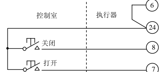
图 4-2 保持式打开/关闭控制，行程可逆，但不能停在途中位置
